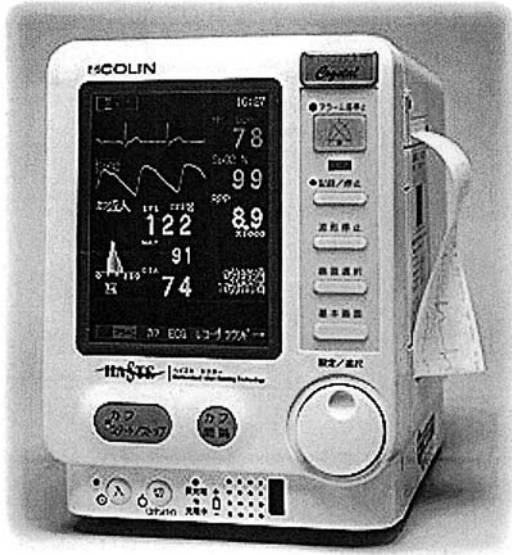
図4： モニタ。この機器により、非観血的血圧、脈拍数、心拍数、心電図波形、脈波形、RPP、経皮的酸素飽和度の測定が可能である。
